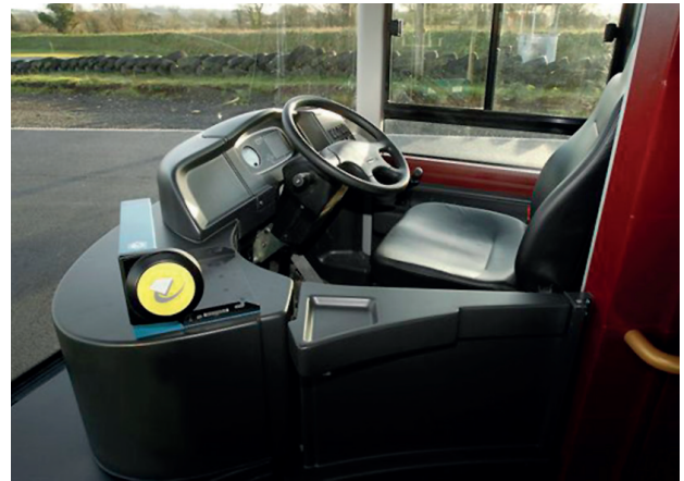
Figura 9: Cabina del conductor del nuevo Routemaster
