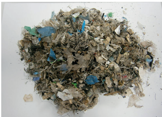
Figura 11: Plástico triturado añadido al hormigón
