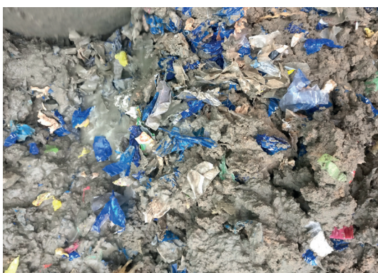
Figura 11: Plástico triturado añadido al hormigón
